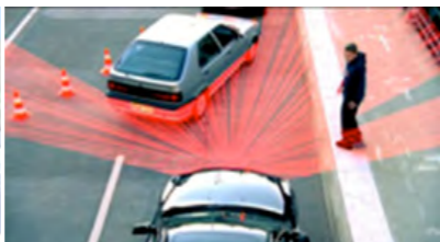
利用雷射掃描，在自動駕駛時，分析並預期周圍事物的變化。
